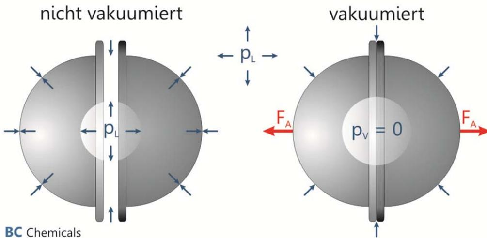
Hydrostatischer Luft-/Atmosphärendruck genormt für Meereshöhe
